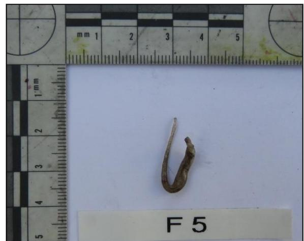
Ilustración 52: fragmento de vidrio con deformación por alteración térmica.
